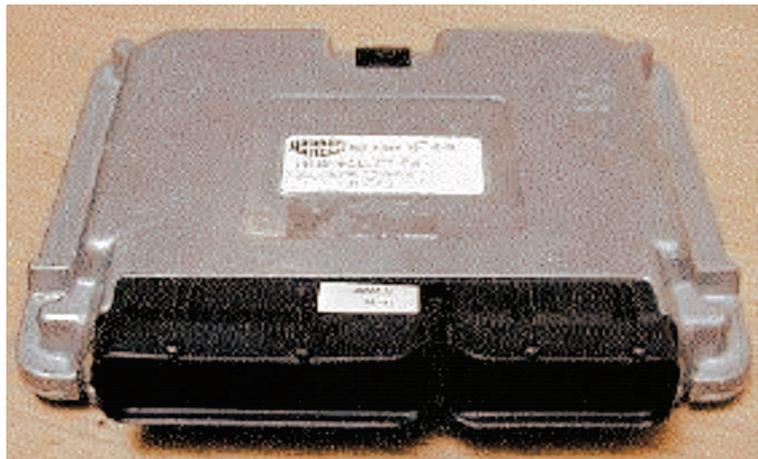
**Figura 1-2 Centralina di sviluppo Magneti Marelli**
