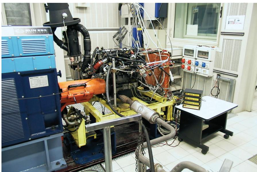
Figura 3-1 Banco Motore per taratura parametri modello
